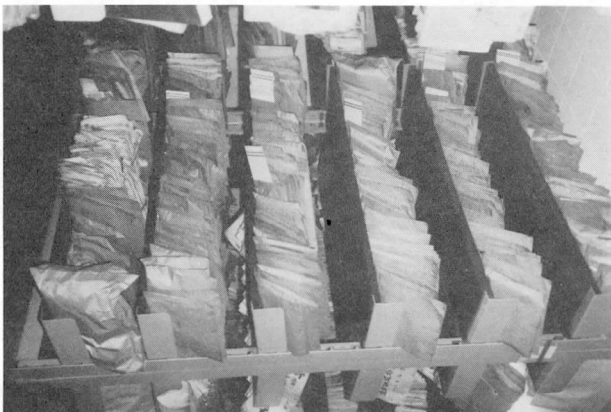
写真1 酸性クラフト紙封筒に入れられた配架状況。特に下段の封筒表面は埃の付着や紙自体の劣化が顕著である。
