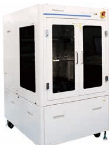
図2 導入予定の微小部蛍光X線分析装置XGT-9000SL。 写真提供: 株式会社堀場製作所
