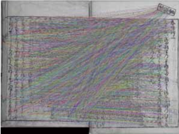
① 2枚の画像から抽出した特徴点の対応付け
